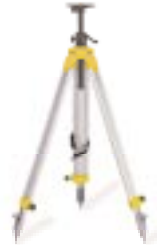
Tip BST-S Ayrılmayı önleme tertibatlı, çabuk kilitleme tertibatlı ve taşıma kemerli üç ayak Yükseklik: yak. 160 cm Ağırlık: 4,5 kg
